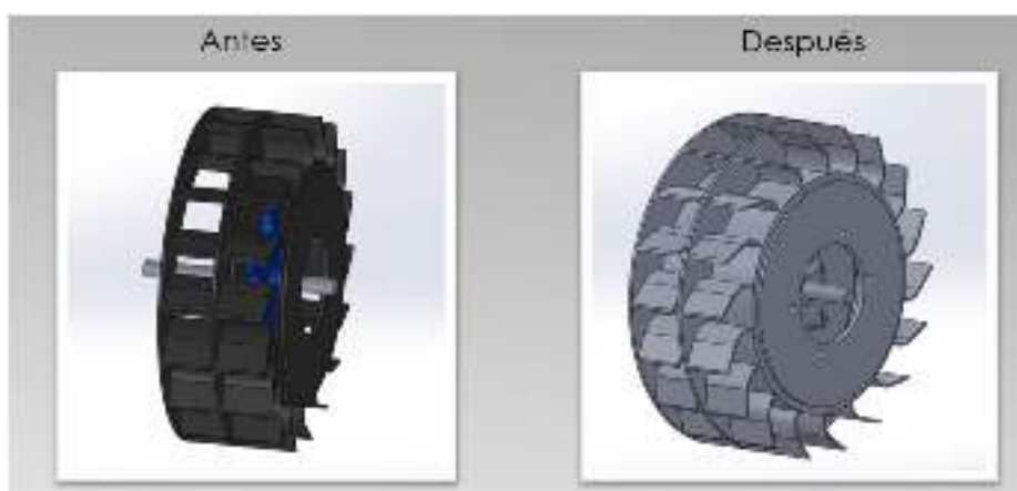
Fig. 6. Comparación entre la versión original y la mejorada del aerogenerador
