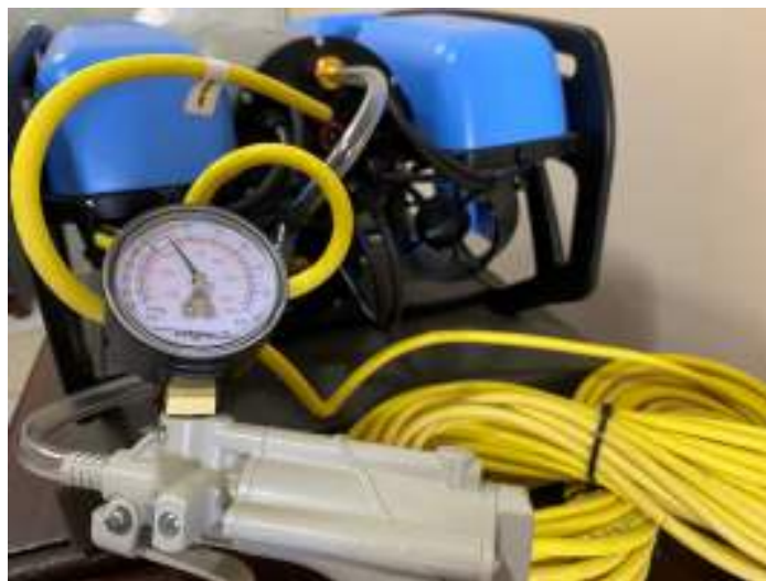
Figura 16 Prueba de vacío del robot submarino BlueROV R3
