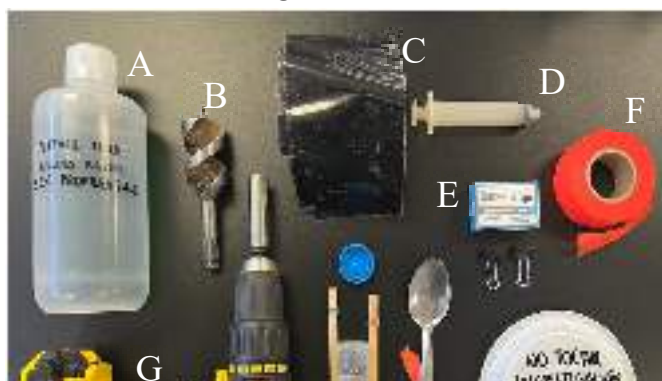
Fig. 1. Materiales usados para el trampeo. A) Contenedor de propilenglicol. B) Broca de perforación. C) Cinta de sellado de tuberías. D) Jeringa. E) Clips. F) Cinta de marcaje. G) Taladro. H) Tubo de centrífuga Falcon con ligas y palitos de madera. I) Cuchara. J) Plato desechable.
