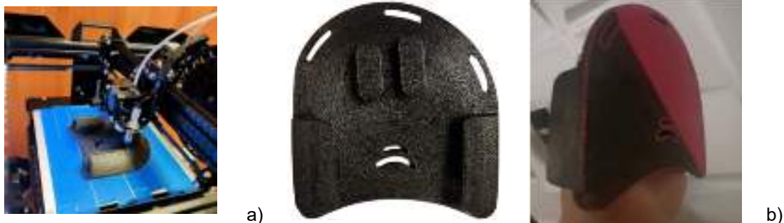
Fig. 8. a) Proceso de impresión 3D y b) paleta derecha finalizada.
