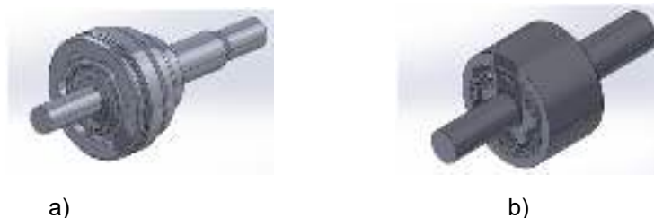
Fig 3. a) Junta homocinética de lado rueda, b) Junta homocinética de lado caja
