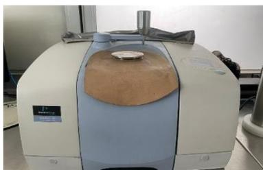
**Figura. 2.** Equipo FTIR-ATR para la caracterización de HNTs
