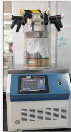
**Figura 6.** Perlas secadas en liofilizadora
