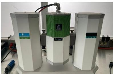
**Figura. 3.** Equipo TA Instruments DMA8000 para el análisis mecánico dinámico de las muestras
