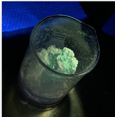
**Fig. 1.** Fotografía del aluminato de estroncio después de síntesis por combustión y antes del tratamiento térmico.
