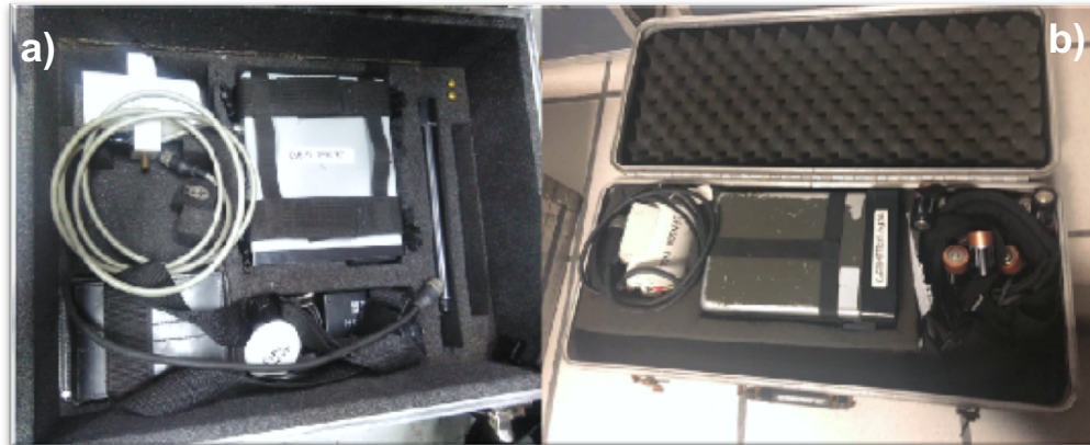
Fig 2. a) Equipo GEM – GSM- 19 para la exploración del subsuelo y b) Geometrix G-856 equipo utilizado para estación base.
