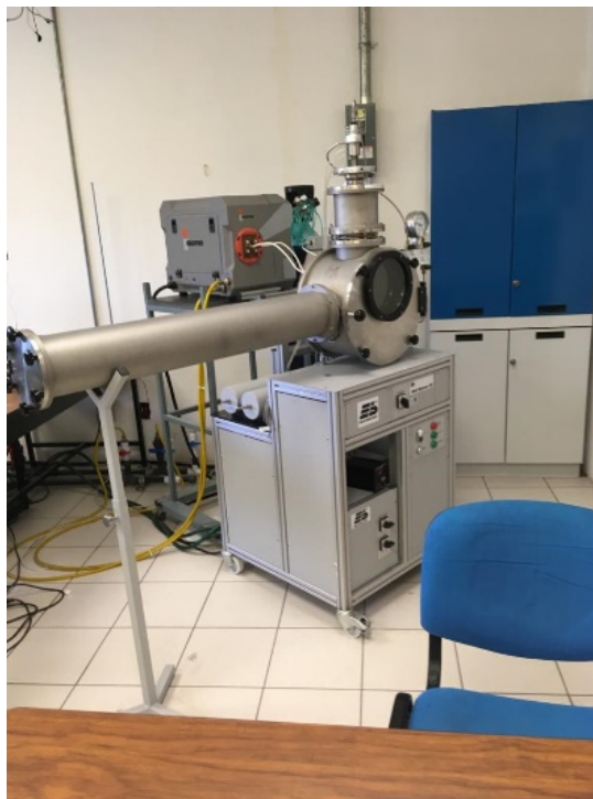
Fig. 3. Sistema Melt-Spinning modelo SC de Edmund Bühler.
