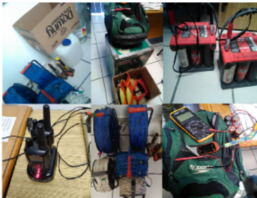
Fig. 4 Equipo para llevar a cabo el método de sondeo eléctrico vertical.
