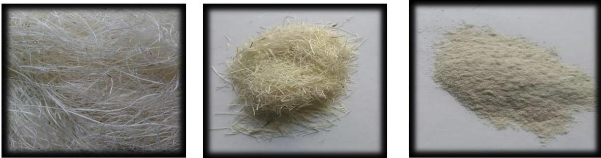
**Fig 1.** fibra natural sin modificación. **Fig 2.** Fibra natural reducida de tamaño. **Fig 3.** fibra natural molida
