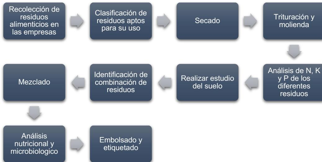
**Fig. 1.** Diagrama de proceso diseñado para la producción de fertilizante a partir de residuos de alimentos (Adaptado de de la Cruz et al., 2006)
