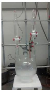
**Figura 4. Sistema de reacción montado para la epoxidación del doble enlace en el anillo.**
