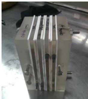
**Figura 1. Celda de electrodiálisis escala laboratorio**
