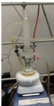
**Figura 3. Sistema de reacción para la alquilación del nopol con bromuro de alilo.**
