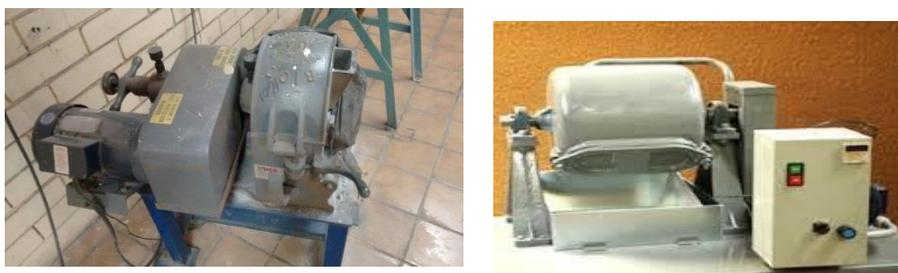
**Figura 1. Trituradora BICO INC y Molino de bolas BICO INC.**
