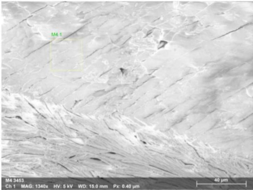
**Figura 2. Análisis de la capa anódica a condiciones en Microscopía Electrónica de Barrido (MEB) bajo condiciones de 60 °C de la solución electrolítica, con inyección de aire.**
