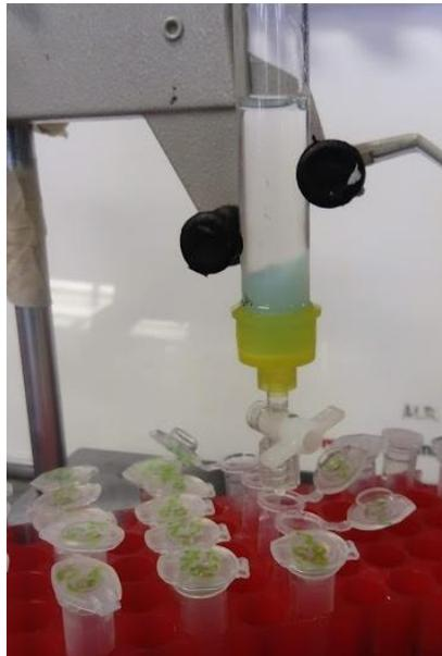
**Figura 3. Montaje de columna del sistema de purificación Ni-NTA de Invitrogen®.**
