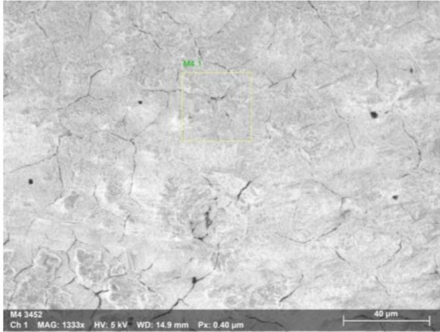
**Figura 2. Análisis de la capa anódica a condiciones en Microscopía Electrónica de Barrido (MEB) bajo condiciones de 60 °C de la solución electrolítica sin inyección de aire.**
