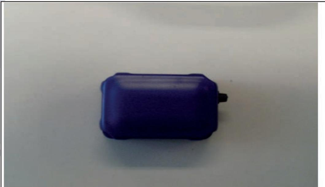
**Figura 1. Sensor MTX Xsense utilizado.**
