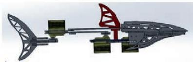
**Figura 5 Nuevo diseño con servomotor de la cola invertido.**
