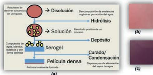
**Figura 3. (a) Método Sol - Gel para la elaboración de películas delgadas, (b) Muestra de Cerasus Sirope, (c) Muestra de Hibiscus Sabdariffa [3].**
