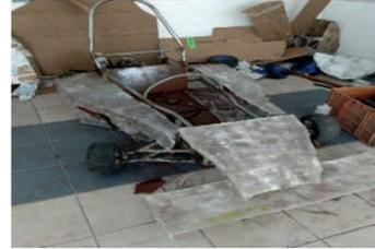
**Figura 4. Carrocería completa y lijada**
