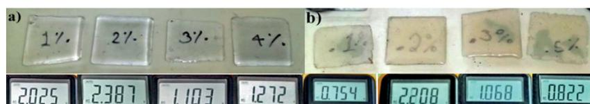
Figura 8. PDMS con distintas concentraciones y voltaje; Nanoestrellas de quitosano (a) y nanoestrellas de óxido de zinc (b).
