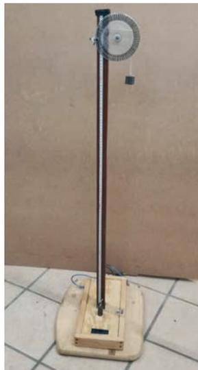
Figura 6. Montaje de sensores    Figura 7. Máquina de Atwood automatizada.
