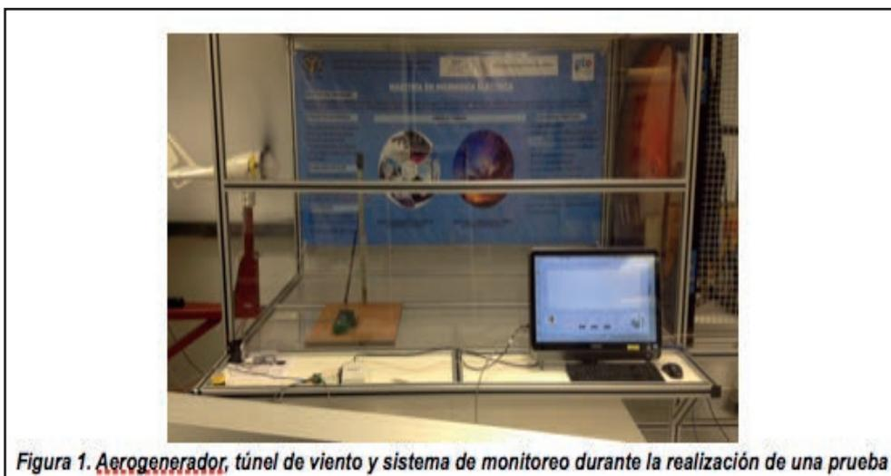
**Figura 1. Aerogenerador, túnel de viento y sistema de monitoreo durante la realización de una prueba**
