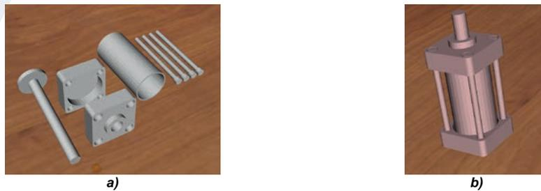
Figura 6. Cilindro neumático, a) piezas por separado, b) ensamble terminado
