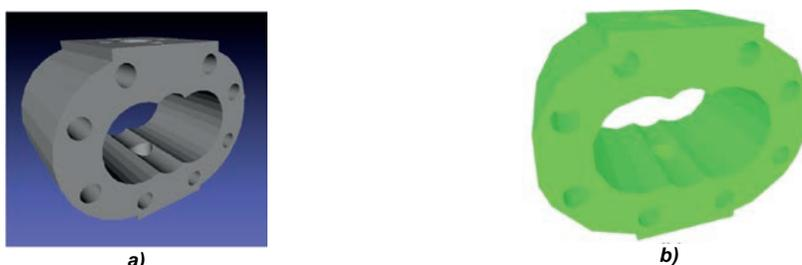
**Figura 2. Representación malla triangular, a) modelo original, b) representación no convexa.**
