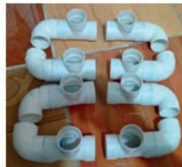
Figura 4: Ensamble codo-tee
