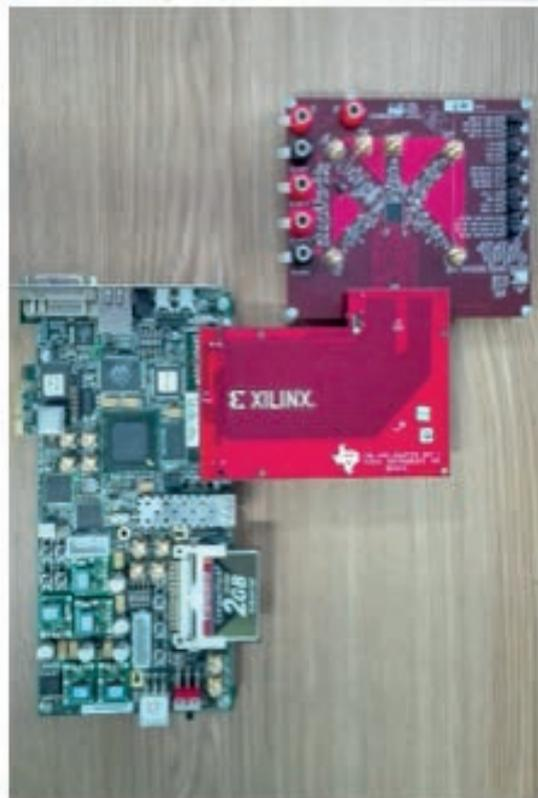
**Figura 4. Spartan6 conectado al módulo ADS mediante un adaptador FMC-ADC**
