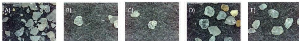
**Figura 3. Micrografías a 200X de granos de arena AS-01 sin atrición (A); y con atrición a velocidad constante de 900rpm durante 15min (B); 30min (C); 60min (D); y 120min (E).**
