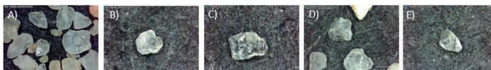
**Figura 4. Micrografías a 200X de granos de arena AS-02 sin atrición (A); y con atrición a velocidad constante de 900rpm durante 15min (B); 30min (C); 60min (D); y 120min (E).**
