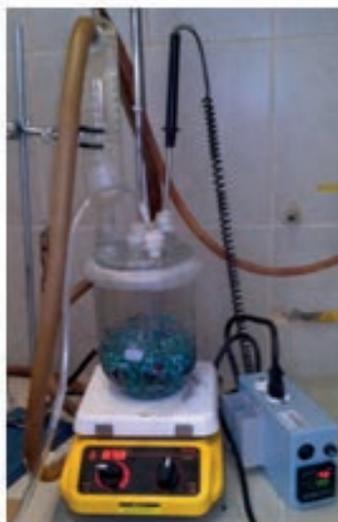
**Figura 1. Montaje de reactor y materiales para la reacción**
