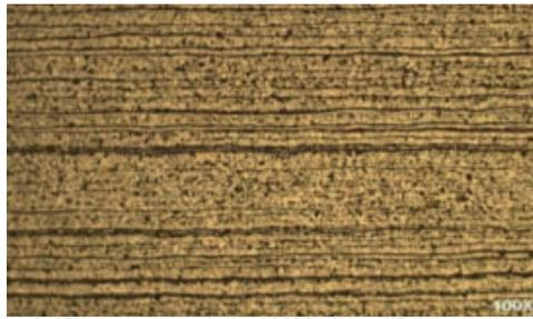
Figura 4. Microestructura a 100X placa "B" con tratamiento
