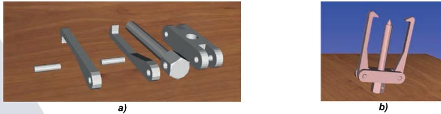
Figura 5. Extractor de poleas, a) piezas por separado, b) ensamble terminado
