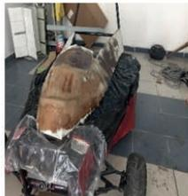
**Figura 5. Aplicación de la fibra de vidrio**
