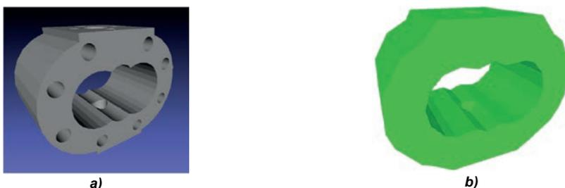
**Figura 3. Representación de descomposición convexa, a) modelo original, b) representación HACD.**
