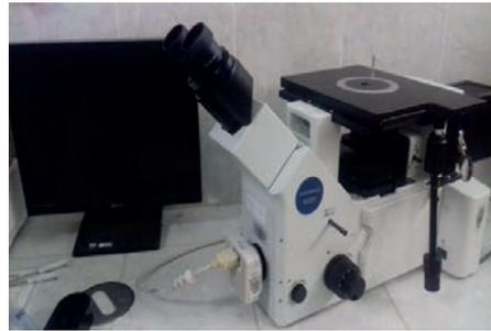
Figura 2 Imagen del Microscopio óptico OLYMPUS GX 51
