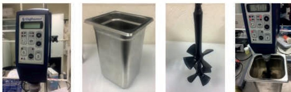
**Figura 1. Sistema para la atrición de arena sílice: motor de velocidad variable (izquierda), recipiente de atrición y mezclador para atrición (centro) y atrición de una suspensión de arena (derecha).**
