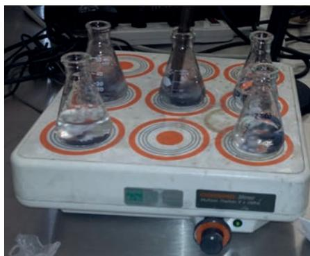
2.- Después de terminar el experimento, se almacenan 0.5 gramos de carbón activado para uso posterior, y lo sobrante se coloca en 25 ml de agua desionizada a 60°C por 1 hora en un orbital a 3 rpm, para desorber el xantato del carbón activado.
