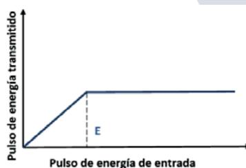
Figura 1. Transmitancia de un limitador óptico ideal para un láser pulsado.
