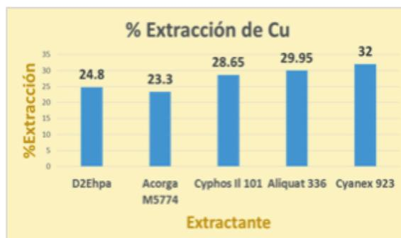
**Fig. 2 En la gráfica se puede apreciar el porcentaje de extracción de Cu de cada uno de los extractantes a las mismas condiciones.**
