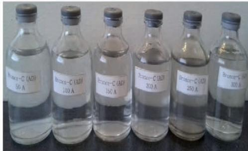
**Figura 2. Muestreo de los experimentos realizados mediante arco eléctrico inmerso en agua destilada, variando la corriente eléctrica.**
