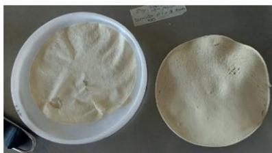
Figura 2. Ejemplo de películas de papel obtenidas en los tratamientos, la de la izquierda es con las fibras de este proyecto y la de la derecha con las del otro proyecto.
