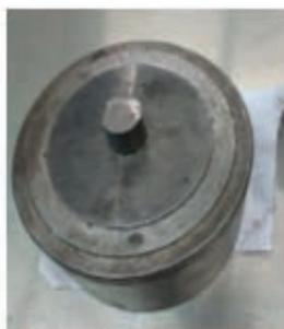
**Figura 1. Dado utilizado para el prensado.**
