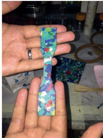
**Figura 3.- Probeta realizada bajo la norma ASTM D638 2003.**
