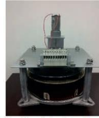
**Figura 4. Diseño final de transformador variable.**
