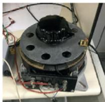
**Figura 1. Autotransformador Variac Monofásico.**
