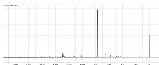
Figura 10. Espectro de ^{13}\text{CRMN} del complejo de silicio-NCS utilizando como solvente \text{CDCl}_3 , obtenido después de la extracción con éter etílico.
