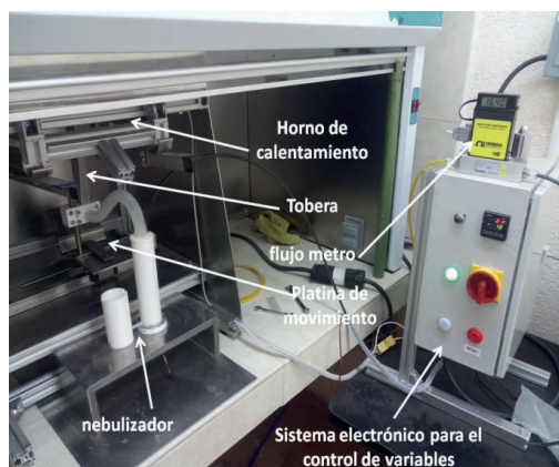
figura 2.- Equipo de deposición química de vapor asistida por aerosol (CVD-AA)
