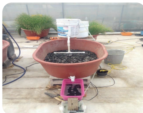
Figura 2 Humedal con Escoria como sustrato.
