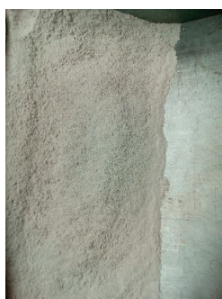
Figura 3. Mineral de Celestita Pulverizado y tamizado a 400 mallas (0.40mm)
