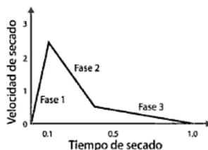
**Figura 2. Etapas del proceso de liofilización**
