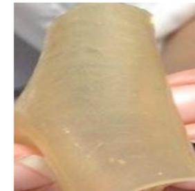
Película hecha en molde de teflón agitando por 1 hora por medio de agitación mecánica, a la cual en lo particular se le añadió PVA y se dejó incubar por 24 horas a 28 °C.
