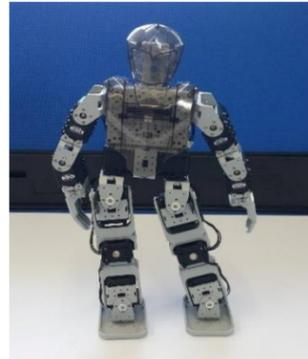
Figura 4. Robot humanoide BIOLOID de robotis premium.
