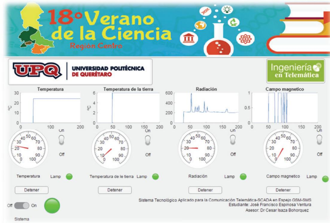
Figura 4 Interfaz gráfica que se desarrolló para el sistema SCADA.
