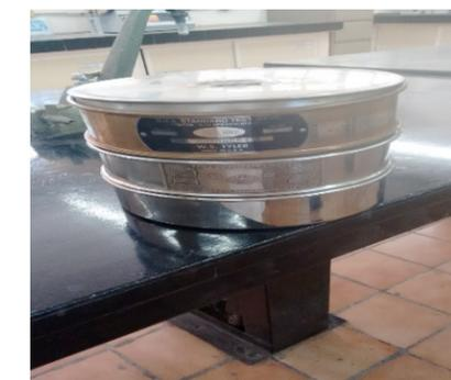
Figura 1. Proceso de Tamizado
