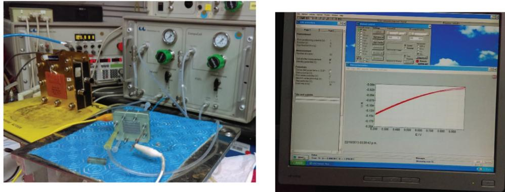
Figura 7. A) Estación de evaluación de celdas. B) grafico de evaluación de celda.
