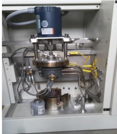
**Figura 2.- (a) vista frontal del reactor CREC Riser Simulator**
