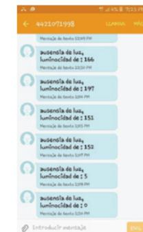
Figura 8. SMS de sensor de ausencia de luz.
