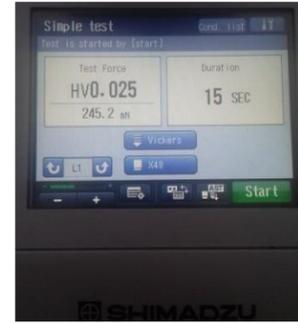
Figura 4.- Condiciones del durómetro.
