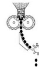
**Figura 1 Esquema del proceso convencional de briquetización en caliente.**
