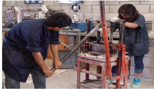
**Figura 4. Elaboración de adobes en el laboratorio de mecánica de suelos y materiales UAMZM**
