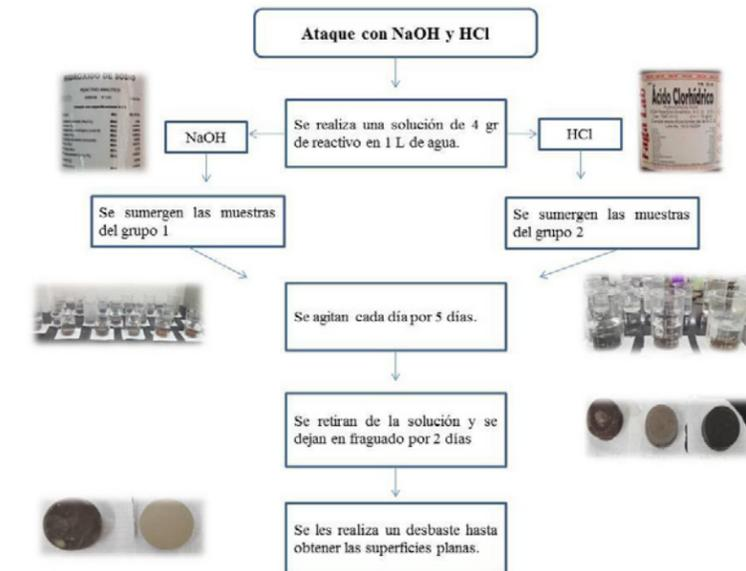
Figura 3. Proceso de ataque con NaOH y HCl.
