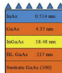
Figura 3. Estructura del 3er. crecimiento.
