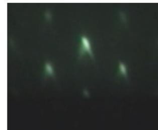
Figura 5. Patrón RHEED en la dirección [1-10] (formación de chevrones) del 2do. Crecimiento.
