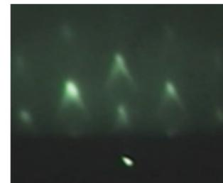
Figura 6. Patrón RHEED en la dirección [1-10] (formación de chevrones) del 3er. Crecimiento.
