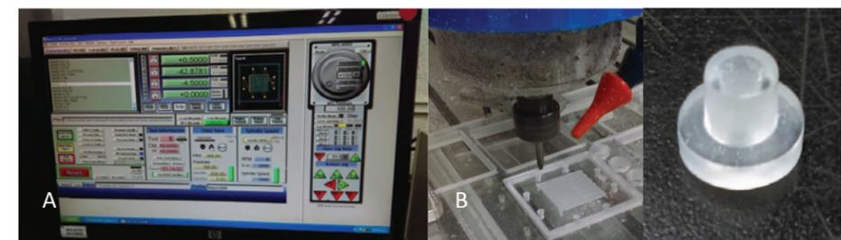
Figura 2. A) Pantalla CNC, B) maquinado de la placa de cierre y flujo
