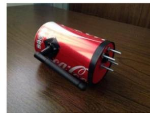
Figura 4. CanSat armado dentro de la lata.
