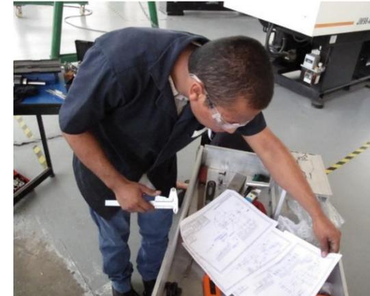
**Figura 1. Fotografía observando planos de fabricación antes de maquinar**
