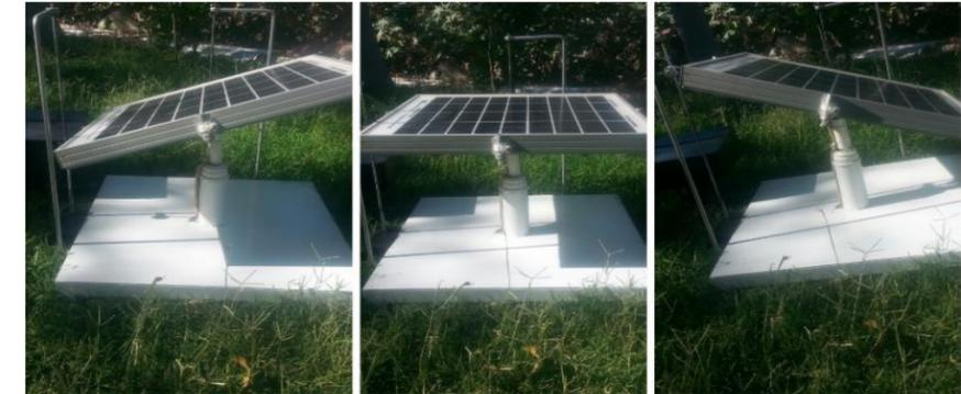
**Figura 5. Seguidor solar autónomo en fase terminada.**
