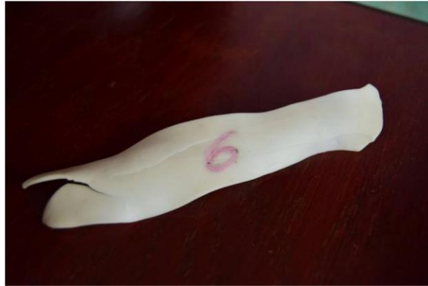
Figura 1. Mezcla cerámica con exceso de aluminio-silicio
