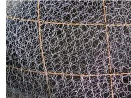
**Figura 1. Membrana utilizada para la construcción de estructuras con ferrocemento**
