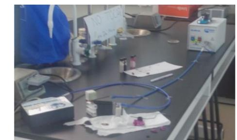
Figura 15: Equipo empleado para la medición de la absorbancia de las películas en el Uv-Vis.
