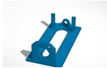
Figura 1. Soporte diseñado en Tinkercad para colocar todos los elementos del CanSat.
