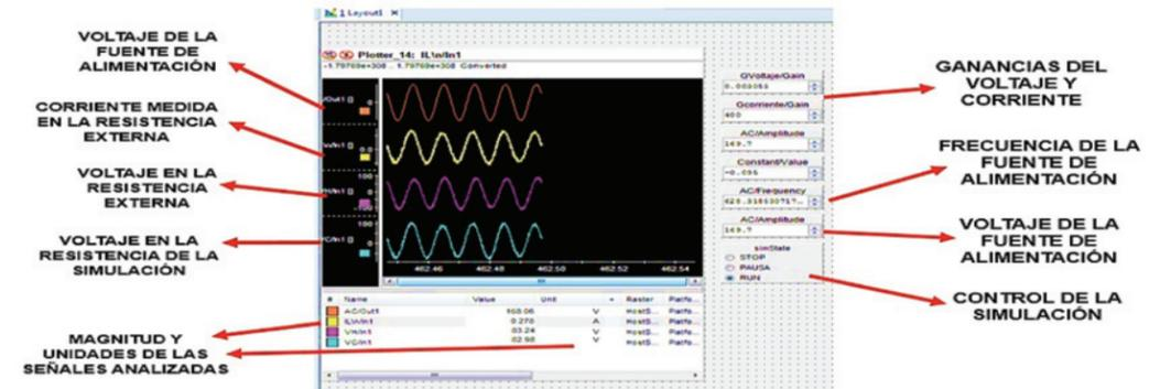
Figura 3. El software ControlDesk permite el control sobre la entrada y salida de las señales.
