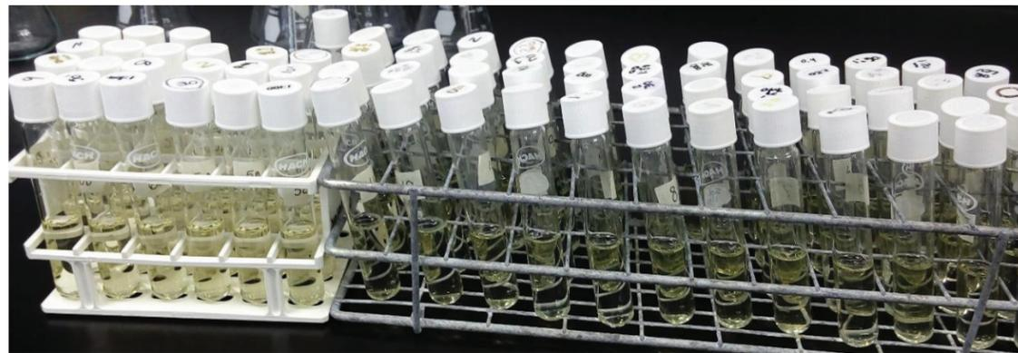
Figura 2. Se muestran los 70 viales ajustados de pH 5 a 11 después de haber sido inoculados.
