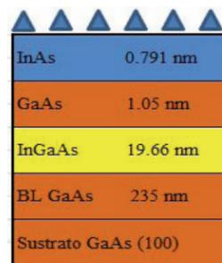
Figura 1. Estructura del 1er. Crecimiento.
