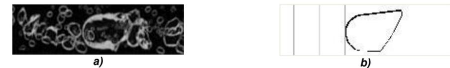
**Figura 4. Detalle de una burbuja de Taylor: a) imagen original, b) imagen de la selección manual [2].**
