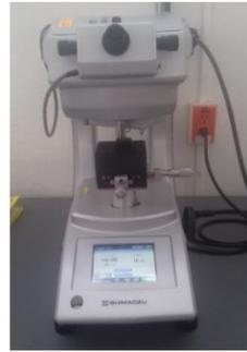
Figura 3.- Imagen de durómetro Shimadzu.
