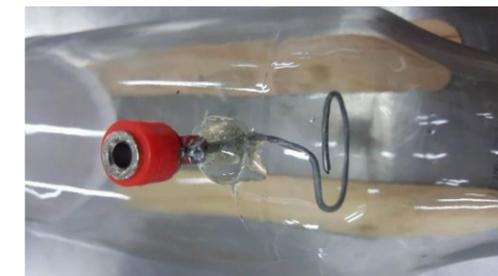
Figura 1. Anillo de acero y orificio sellado con resina epóxica
