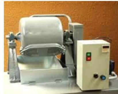
Figura 2. Molino de bolas BICO INC.
