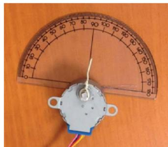
Figura 4. Medición de Giro del motor a pasos
