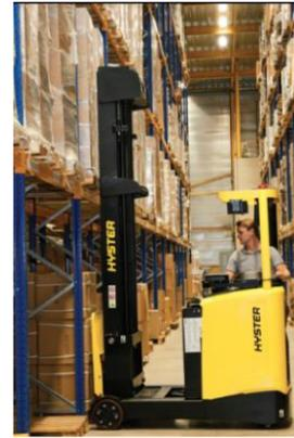
Figura 4. Montacargas Apilador con operador sentado (HYSTER, L. (2015))
