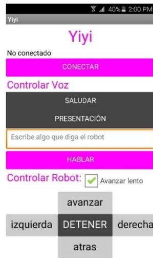
Figura 5. Aplicación para controlar los movimientos y el habla de Yiyi.
