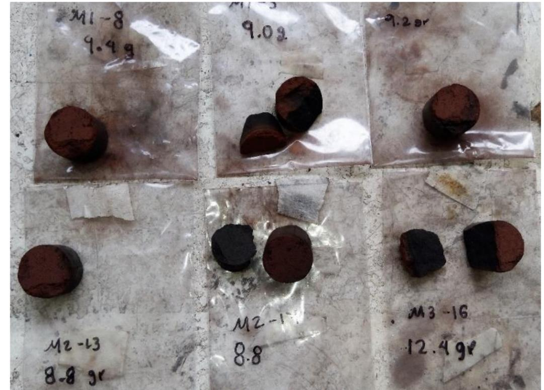
Figura 2. Briquetas en verde posterior al ensayo shatter.
