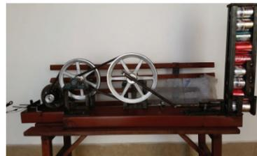
Figura 2. Máquina compactadora de latas de aluminio
