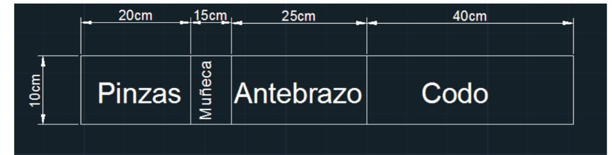
Figura 2 bosquejo de la estructura del brazo robótico
