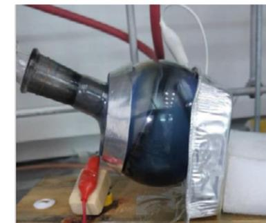
Figura 6. Reactor de plasma rotatorio.
