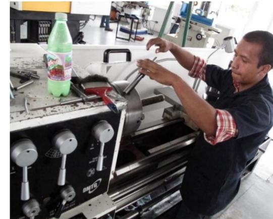
**Figura 3. Maquinado en torno convencional**
