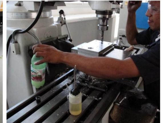
**Figura 2. Maquinado en fresa convencional.**
