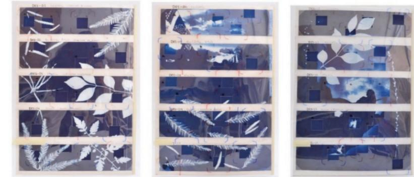
**Figura 1. Fotografía de las 15 muestras montadas en los soportes de cartón con las ventanillas de acetato.**
