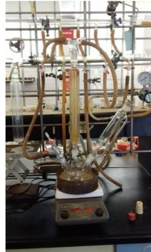
Figura 1. Sistema para síntesis de  $\text{TiO}_2$
